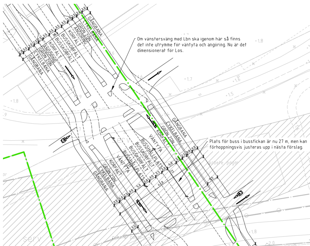
Figur 16. Alternativ med två mittrefuger vid passage i korsningar som blir angöring på sträcka samt busshållplats med genomgående busskör-fält.
