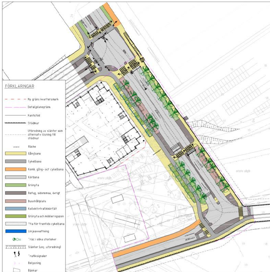
Figur 10. Trafik och utformningsförslag för Kämpegatan, etapplösning.
